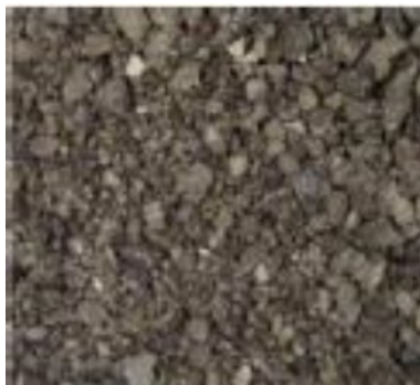
Figura 1: Aspeto e granulometria das misturas betuminosas recuperadas ( MBR )
